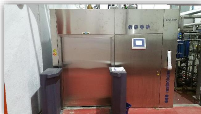
*Ilustración 7.* Autoclave para la esterilización de residuos peligrosos de la empresa Interlun, S.L.
